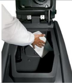
La scelta di posizionare il motore di aspirazione nel coperchio del serbatoio di recupero favorisce la totale pulizia del serbatoio stesso.
