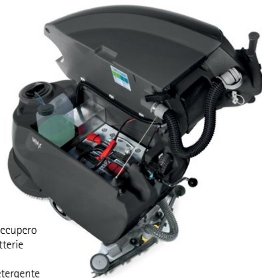
La completa apertura del serbatoio di recupero
