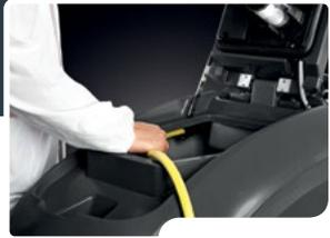
La pulizia periodica del tubo di aspirazione garantisce un'efficiente asciugatura nel tempo
